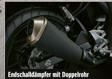
Endschalldämpfer mit Doppelrohr
